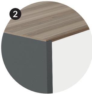
**2** Estructura de mesa con laterales realizados con chapa de acero laminado de 1'5 mm de espesor, plegada y soldada de tal forma que la tapa de la mesa queda embutida dentro del lateral y a su vez, éste envuelve el canto corto de la mesa y oculta el sistema de pasacables telescópico que se desarrolla por debajo de la tapa de la mesa. Pasacables oculto en lateral con desarrollo por debajo de la tapa de la mesa.
