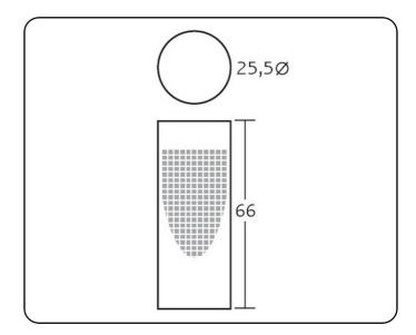
**DESCRIPCIÓN:** Papelera metálica perforada. Tapa superior cromada, desmontable para sujeción de bolsas. Embellecedor negro en la base.
